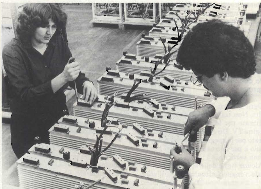
I gruppi di continuità statici sono composti da un raddrizzatore, da un inverter e da una batteria di accumulatori rigidamente collegata ad un circuito intermedio in corrente continua. Queste apparecchiature proteggono carichi privilegiati da mancanze di tensione di alimentazione e mantengono allo stesso tempo costanti i valori di tensione e di frequenza. La foto mostra il montaggio dei componenti dell'inverter nella fabbrica Siemens AG di Erlangen.
