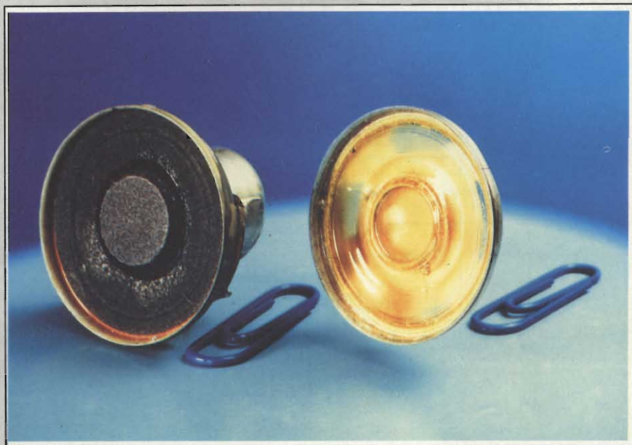
Riduzione della profondità di un piccolo altoparlante ottenuta impiegando un magnete RES (a destra). A sinistra profondità di un analogo altoparlante con magnete Ticonal. Nel primo caso, la profondità dell'altoparlante è 8 mm, nel secondo caso 15 mm.
