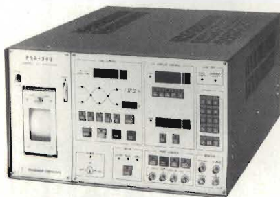
Simulatori di transistori, in grado di simulare qualsiasi perturbazione della rete di alimentazione allo scopo di studiare il comportamento di apparecchi elettronici sensibili a tali perturbazioni.
