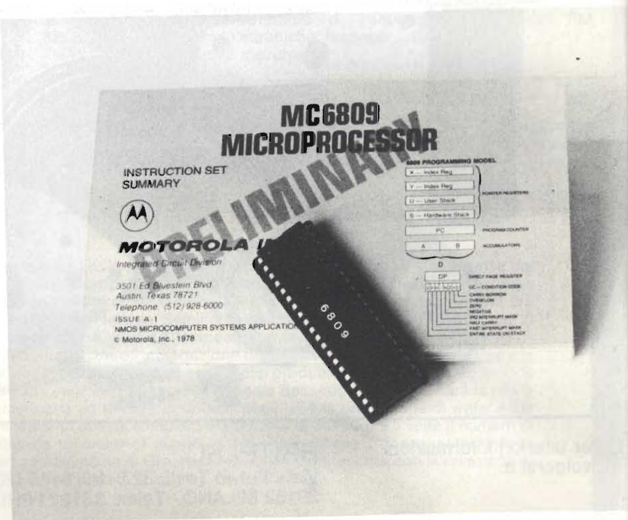
Fig. 1 - La CPU MC 6809.
